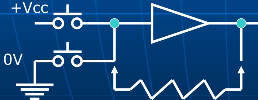
El problema es la carga R de realimentación que degrada la operación de la compuerta.
